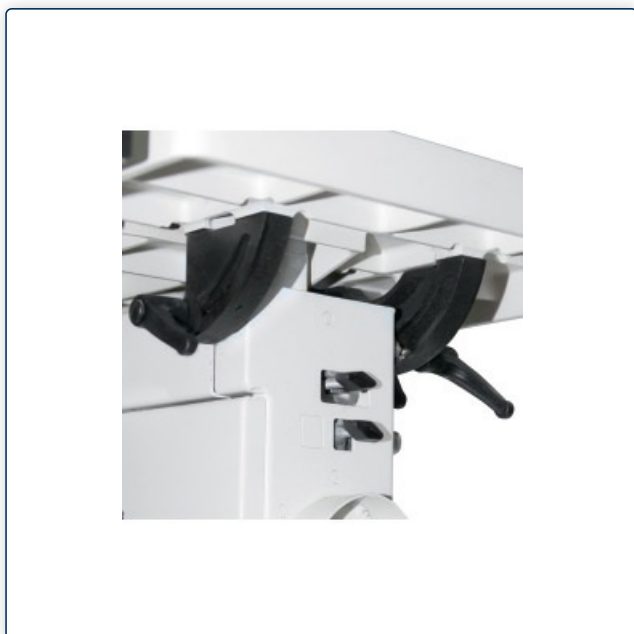
Stół do piłowania z mechanizmem obrotowym wykonany z żeliwa szarego, możliwość obrotu do 20°
