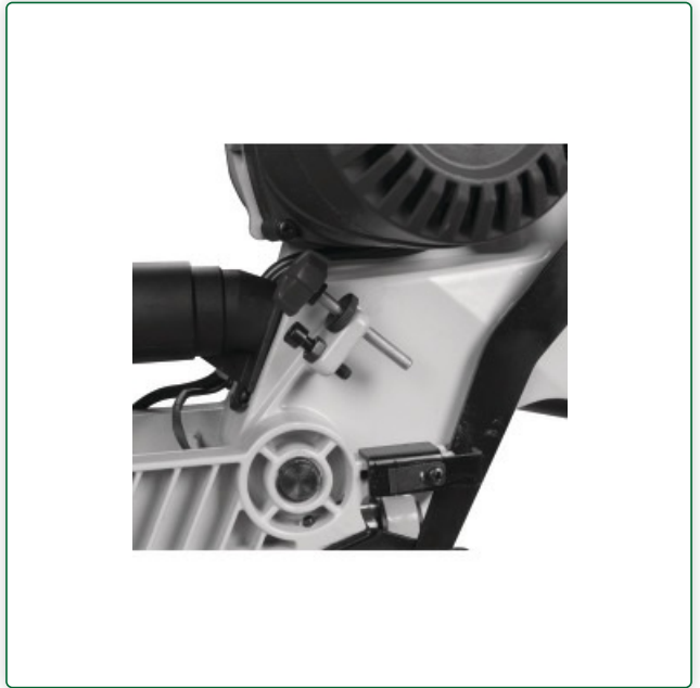
2-krotne regulowane ograniczenie głębokości siekania
