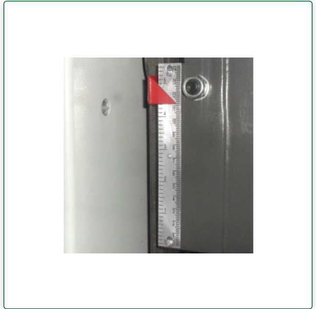
Regulowana wysokość stołu warsztatowego dodatkowo odczytywana na skali
